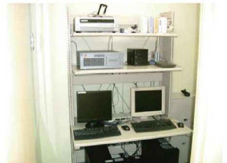
ネットワークカメラを使用するため、レコーダーはどこでも設置可能に。
